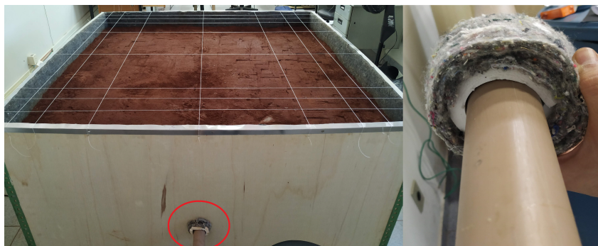
Figura 7 – Revestimento das extremidades do tubo
