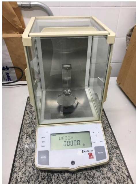
Figura 6 – Fotografia da balança e sistema de medida de densidade.
