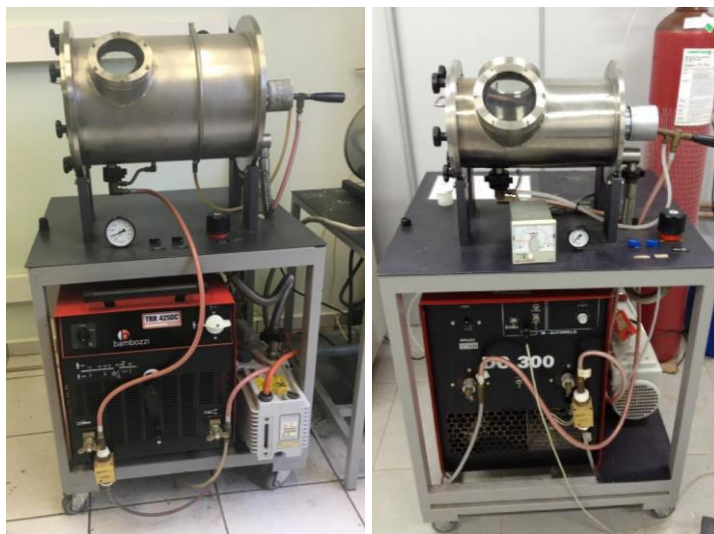
Figura 2 – Fotografia dos fornos de fusão a arco voltaico: (esquerda) equipamento da Unesp Campus Guaratinguetá e (direita) equipamento da Unesp Campus Bauru.
