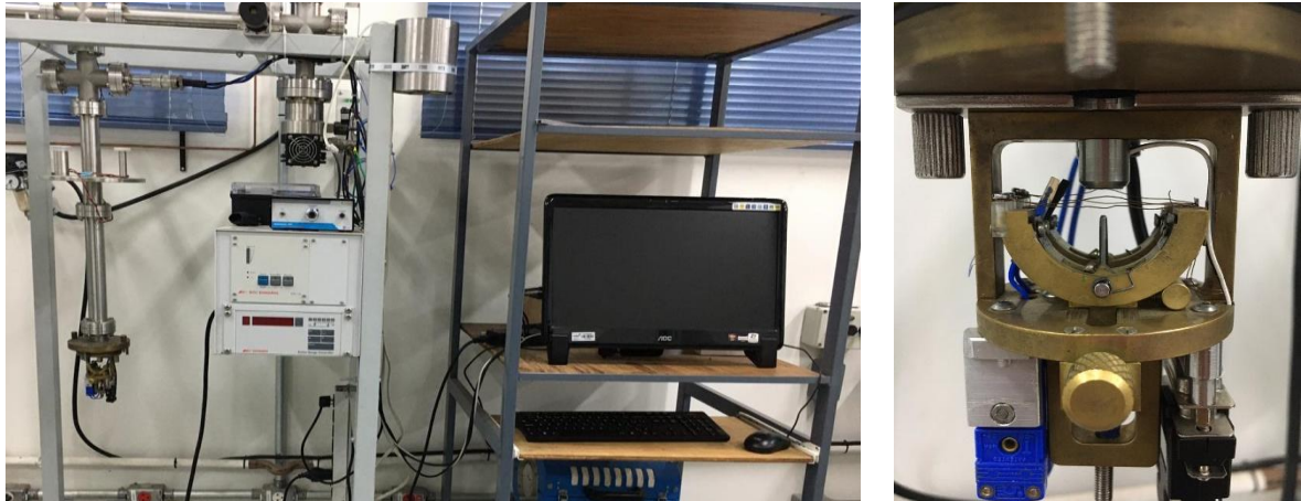
Figura 11 – Fotografias do equipamento de medida de módulo de elasticidade: (esquerda) sistema de medida e (direita) porta amostra.
