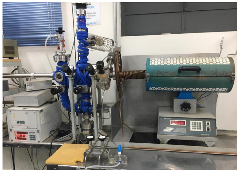
Figura 4 – Fotografia do sistema de tratamento térmico utilizado para os envelhecimentos.
