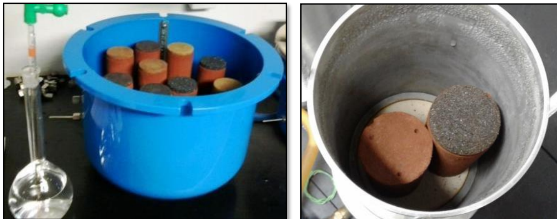
Figura 4-8: Imposição da sucção dos corpos de prova para ensaios triaxiais não saturados.
