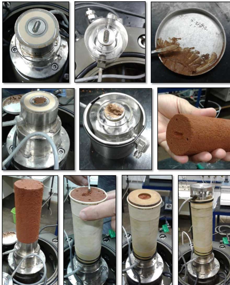
Figura 4-13: Procedimentos de montagem de uma câmara triaxial equipada com bender elements .
