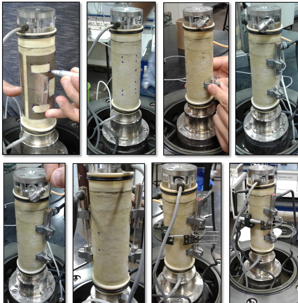
Figura 4-18: Procedimentos de montagem dos LVDTs sobre o CP triaxial.
