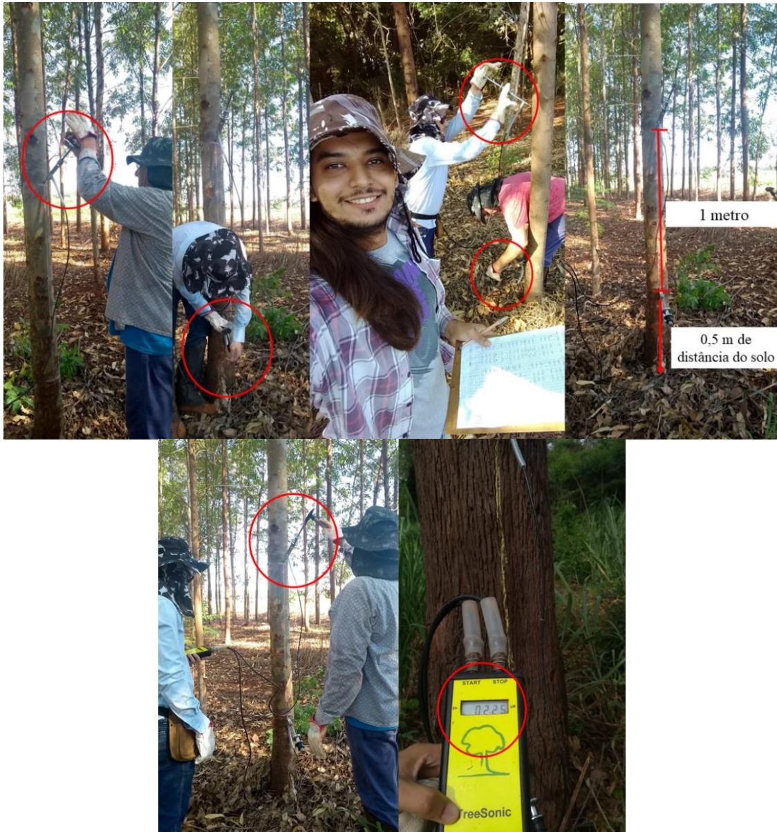
Figura 3 – Utilização do Treesonic para a coleta de dados da velocidade acústica do som.
