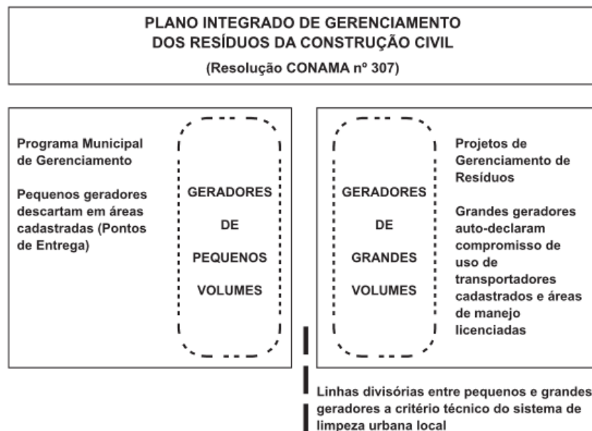
Figura 11 – Modelo de aplicação do gerenciamento de resíduos da construção pelos agentes envolvidos
