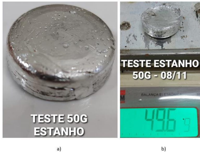
Figura 38: a) amostra obtida no teste de fusão de estanho - 50 g, b) massa final da amostra após retirada escória
