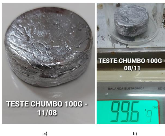
Figura 35: a) amostra obtida no teste de fusão de chumbo - 100g, b) massa final após retirada de escória da fundição
