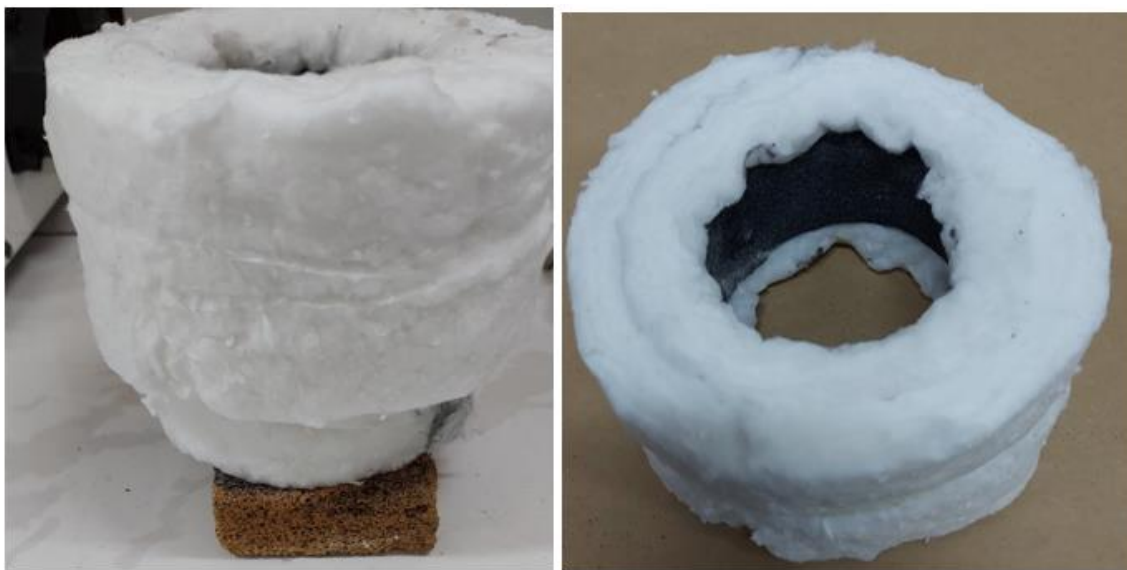
Figura 25: a) Mufla de manta cerâmica para isolamento do anel SiC, b) destaque no anel SiC
