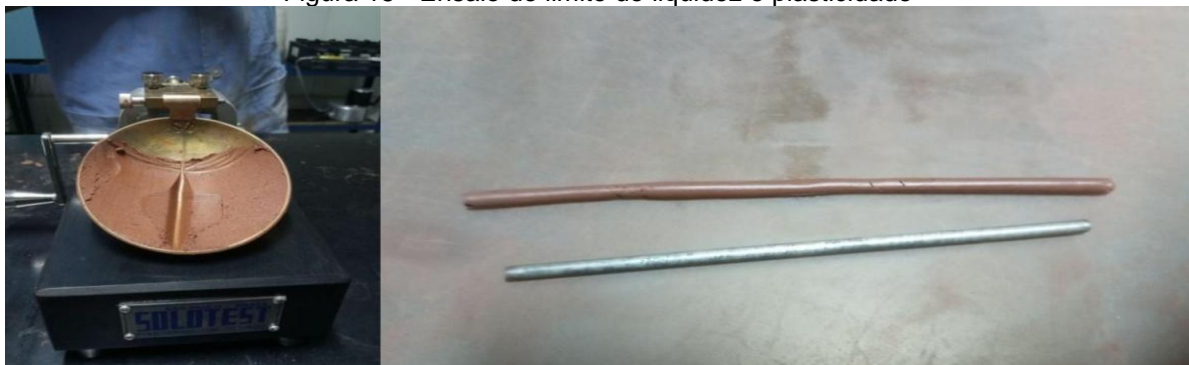
Figura 15 - Ensaio de limite de liquidez e plasticidade
