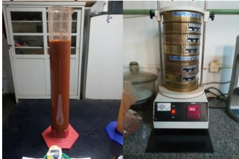
Figura 14 - Análise granulométrica: sedimentação e peneiramento
