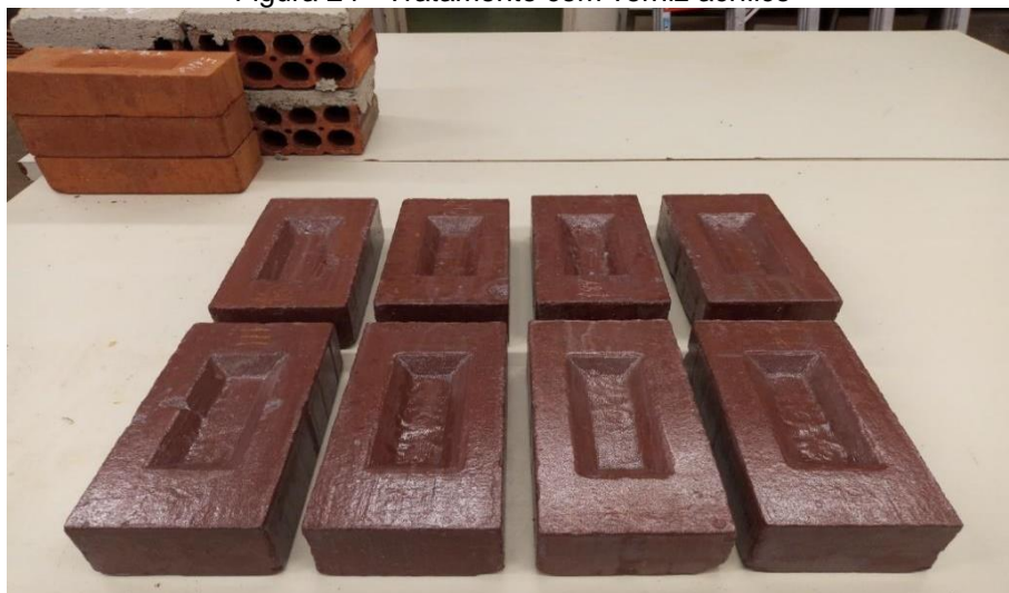
Figura 24 - Tratamento com verniz acrílico
