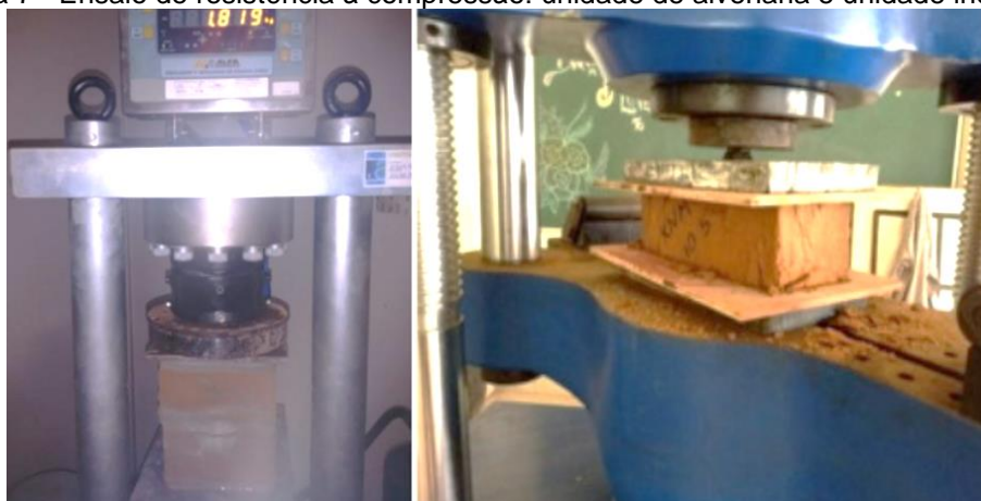
Figura 7 - Ensaio de resistência à compressão: unidade de alvenaria e unidade individual
