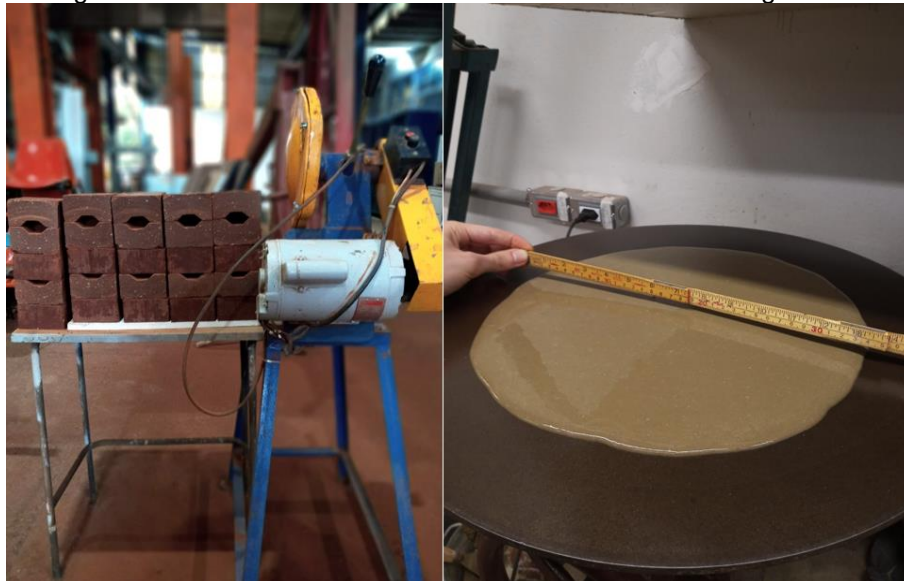
Figura 25 - Corte dos blocos e análise de consistência da argamassa
