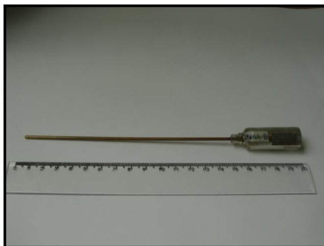
Figura 4. Eletrodo de trabalho : espécime confeccionado resina acrílica ativada quimicamente contendo cilindro da liga Ti-10Mo e montado em fio de cobre
