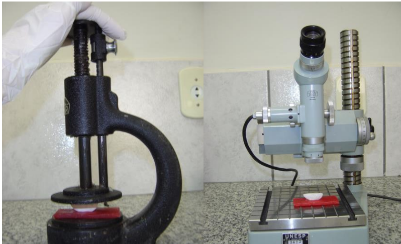
Figura 4 – a) Espécime sob ação do paralelômetro; b) Mensuração do ângulo de contato em microscópio Carl Zeiss
