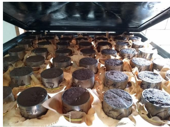
Figura 38. Mesa de tensão com amostras de solo em anéis volumétricos para análise de porosidade e densidade do solo e fertilidade
