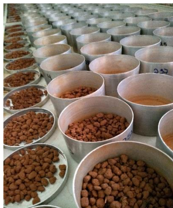
Figura 39. Torrões de solo após passar por peneira de 4mm para avaliação de estabilidade de agregados
