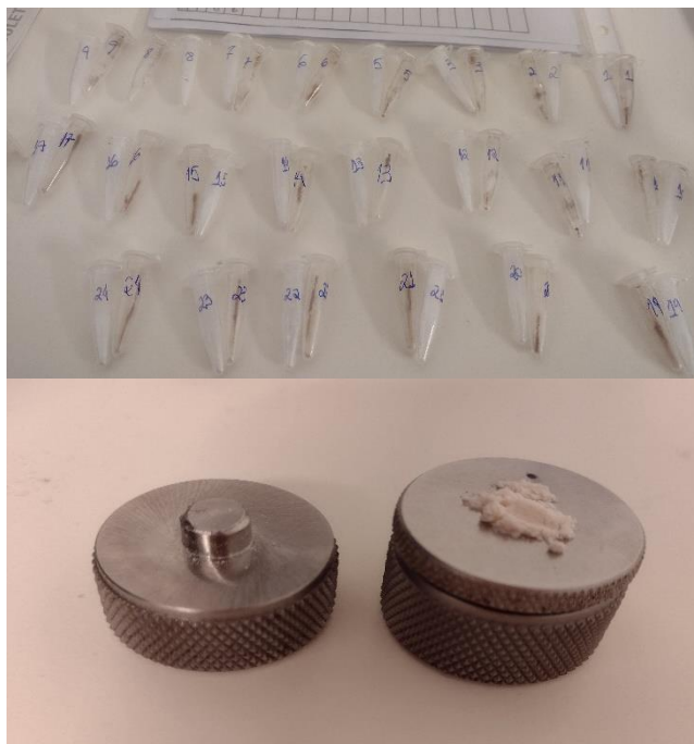
Figura 40. Preparo das amostras de solo + KBr para análise espectroscopia de infravermelho com transformada de Fourier (FTIR)
