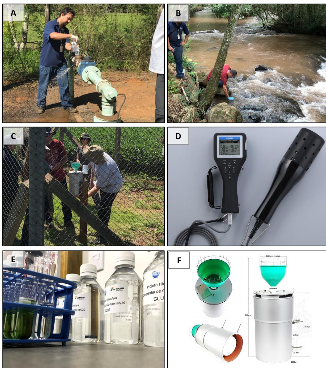
Figura 3.3 – Procedimento de amostragem. A) Amostragem de água subterrânea em poços tubulares; B) Coleta na parte superficial do rio Lopei; C) Coletor de chuva sendo amostrado; D) Modelo de sonda multi-parâmetros utilizada para análises in situ ; E) Detalhe dos vasilhames utilizados para determinação da composição isotópica; F) Modelo do coletor de chuva, Palmex (2019).
