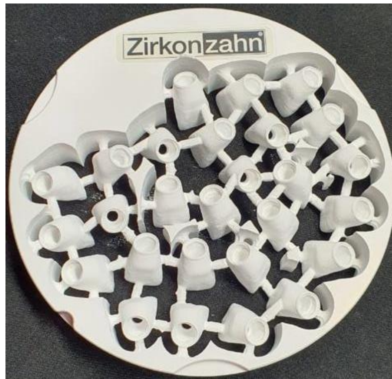
Figura 3 – Resultados dos blocos de zircônia fresado
