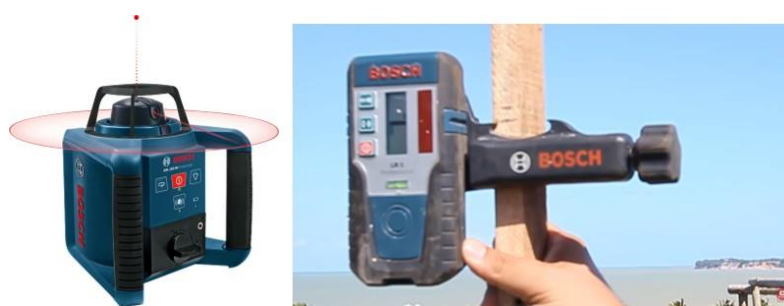
Figura 24 – Nível a laser rotativo e visor do receptor indicando que a região está em nível
