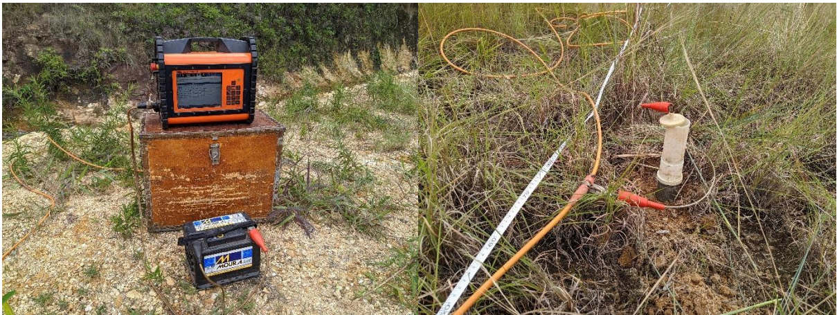
Figura 30 - Na imagem à direita o resistivímetro Terrameter. Na imagem à esquerda o eletrodo de cerâmica montado para a aquisição de dados.
