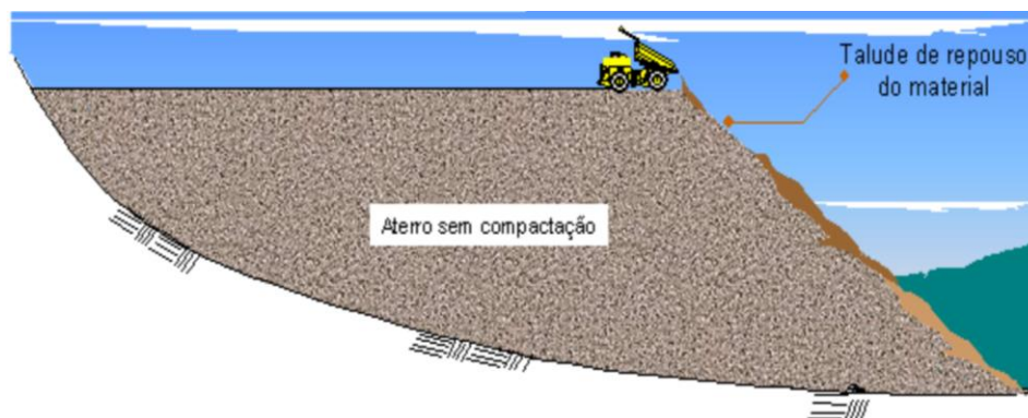
Figura 4 - Método de construção de pilha de rejeito chamado ponta de aterro ( end-dumping ).
