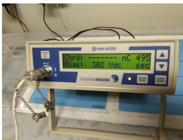
Figura 23 – a) Câmara Farmer de 0,6 \text{ cm}^3 posicionada; b) Eletrômetro acoplado na câmara de ionização. Fonte: Própria do autor.
