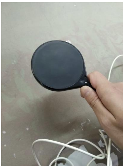
Figura 19 - Câmara Radcal modelo 20x6-60E de placas paralelas. Fonte: Própria do autor.
