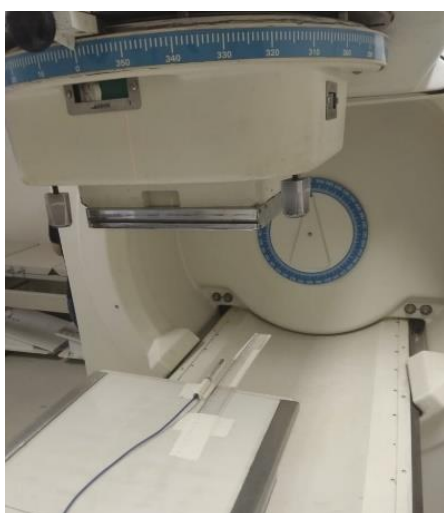
Figura 23 – a) Câmara Farmer de 0,6 \text{ cm}^3 posicionada; b) Eletrômetro acoplado na câmara de ionização. Fonte: Própria do autor.
