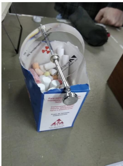
Figura 17 – Aplicador de betaterapia com Fonte de Sr-90. Fonte: Própria do autor.
