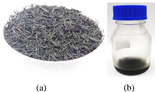
Figura 22 - Produtos obtidos após o processo de pirólise lenta a) biochar e b) Bio-óleo.
