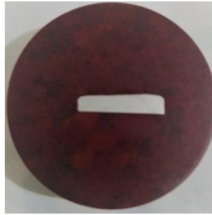
Figura 6 - Posição da amostra utilizada para as medidas de microdureza Vickers
