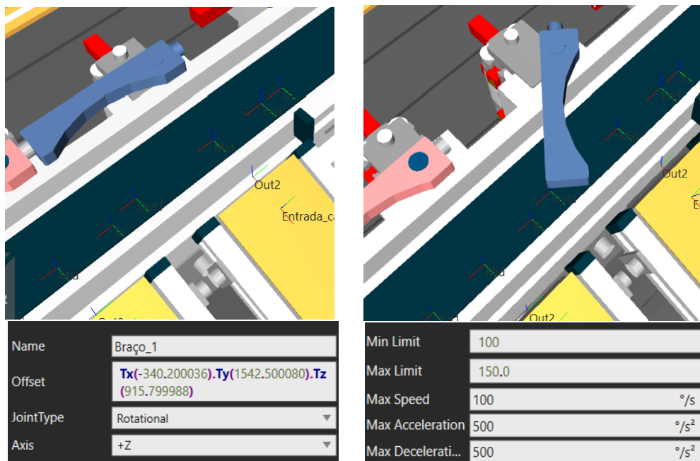
Figura 10: Modelagem e movimentação do Servo Motor 1, indicando seus valores mínimos e máximos de atuação
