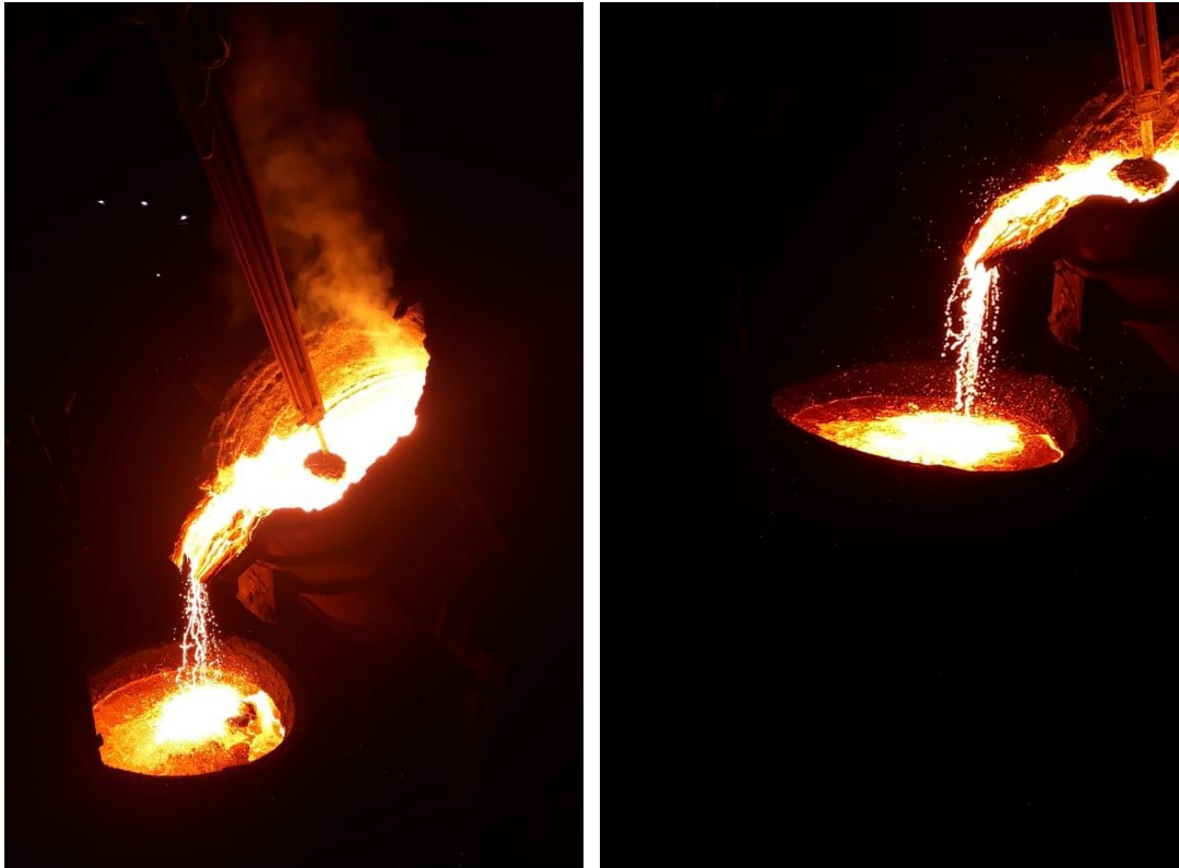
Figura 9 – Retirada de escória da panela
