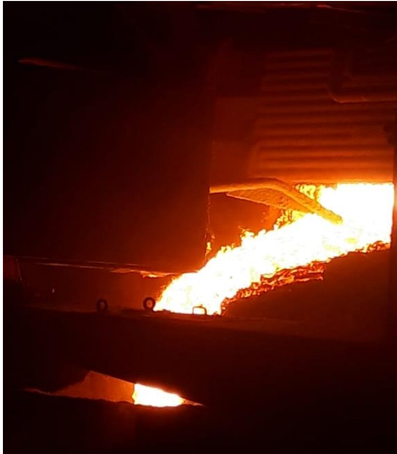
Figura 8 – Escória sendo retirada do FEA antes do vazamento ( slag off )
