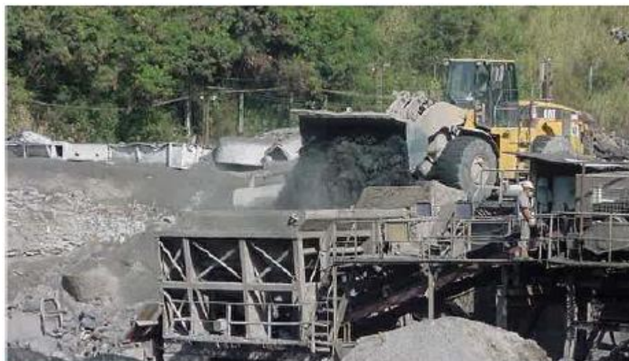
Figura 12 – Abastecimento da planta de beneficiamento
