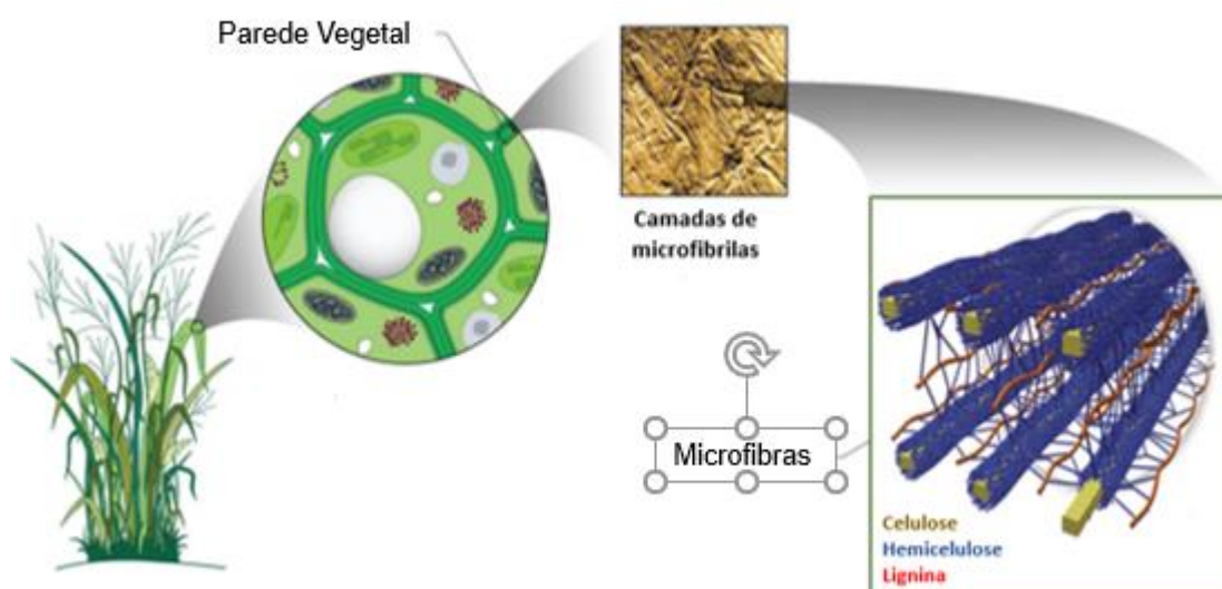
Figura 1 - Esquema da morfologia e composição das fibras lignocelulósicas
