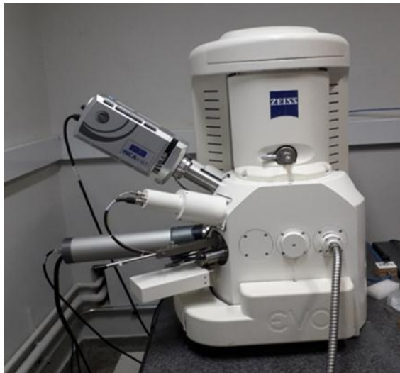
Figura 21. Microscópio Eletrônico de Varredura – MEV (ZEISS, mod. EVO LS15).
