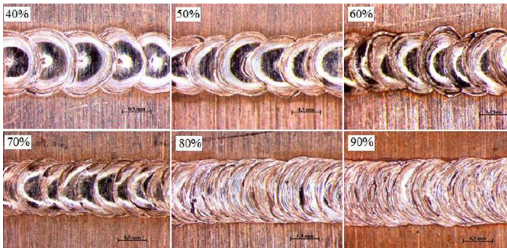
Figura 10. Representação das possíveis sobreposições do cordão de solda no modo pulsado.
