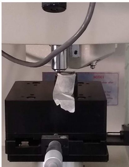
Fotografia 5: Fixação do corpo de prova
