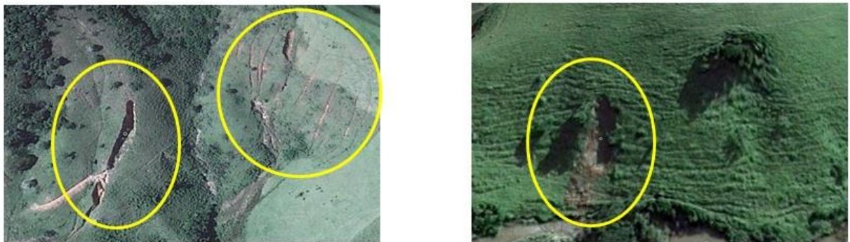
Figura 24 – Diferenciação entre ravinas e cicatriz de deslizamentos de terra
