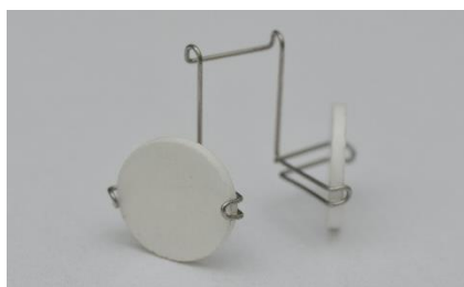
Figura 3 - Aparato metálico que mantém os discos na posição vertical
