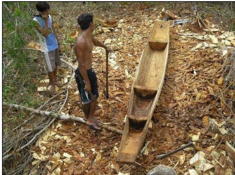
Figura 9: Construção da canoa Guató.
