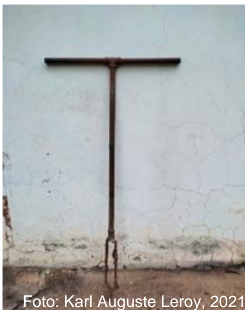
Figura 2 - Trado holandês utilizado na coleta das amostras de solo
