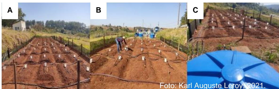
Figura 11 - Disposição dos coletores no ensaio de distribuição de água pelos emissores
