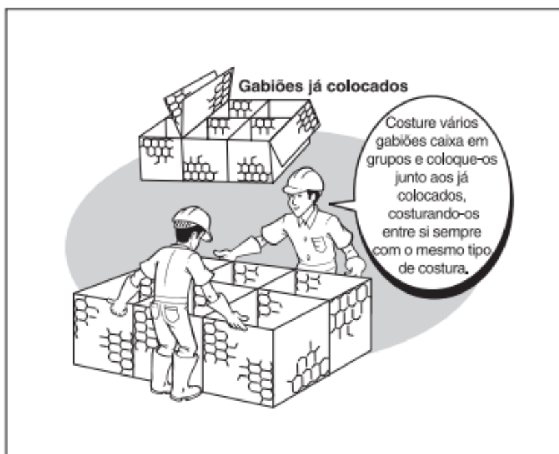
Figura 6: Posicionamento dos gabiões antes do enchimento.
