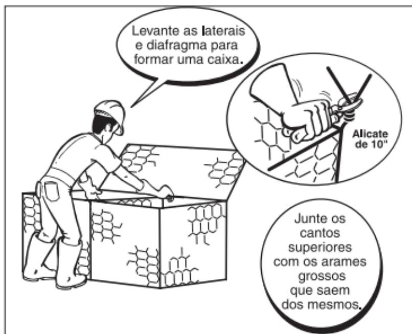
Figura 4: Posicionamento dos painéis laterais e diafragmas.
