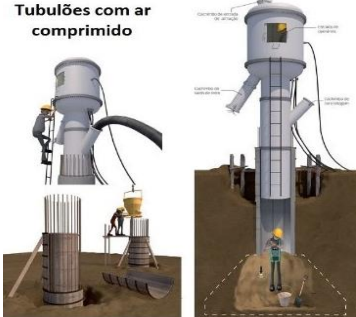
Figura 7 - Execução de tubulão a ar comprimido
