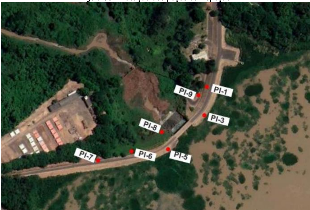
Figura 33 – Locação dos poços de inspeção.
