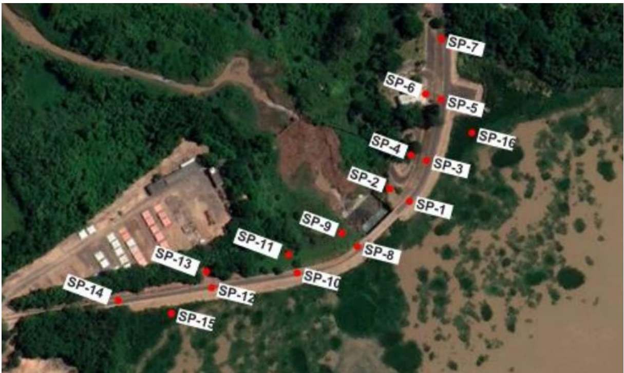
Figura 35 – Localização das sondagens percussivas.
