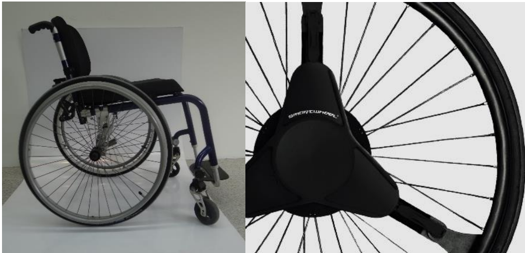
Figura 2.3.19 - Cadeira de rodas Starlite ORTOBRAS e sistema SMARTWheel acoplado a roda propulsora
