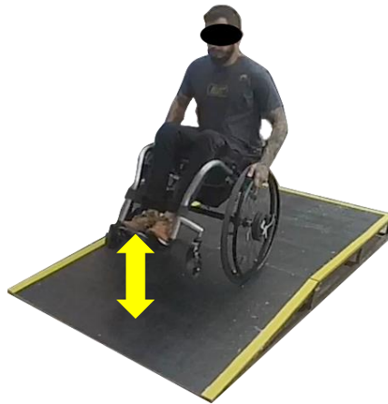
Figura 1.7.6 - Exemplo de usuário empinando a cadeira de rodas durante manobra de descida de rampa
