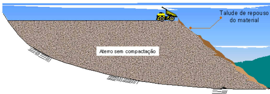
Figura 18 - Desenho esquemático da construção por ponta de aterro.
