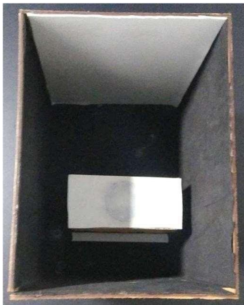
Figura 7. Suporte em madeira forrado com etil vinil acetato (EVA) de cor branca posicionado dentro da caixa controladora.
