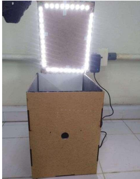
Figura 3. Caixa com controle de luz para a captura de imagens digitais em intensidades luminosas controladas por fita de luzes LED fixadas na tampa da caixa para o ajuste de luminosidade.
