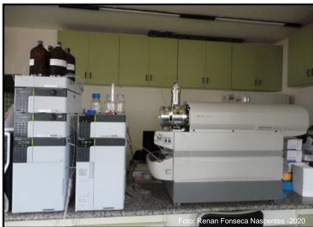
Figura 5 – Cromatógrafo líquido (Proeminence UFLC) acoplado ao espectrômetro de massas (Triple Quad 3200) – LC-MS/MS.
