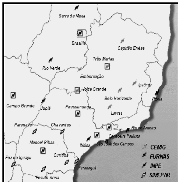
Figura 1. Rede de sensores de descargas atmosféricas do Brasil. Fonte: www.Rindat.com.br
