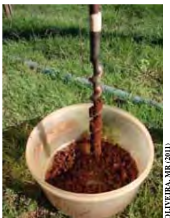
Figura 10. Coletando amostras de solo com trado tipo rosca
