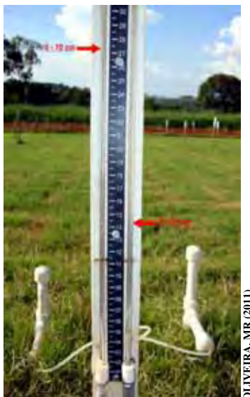
Figura 9. Tensiômetro de mercúrio instalado na área experimental
