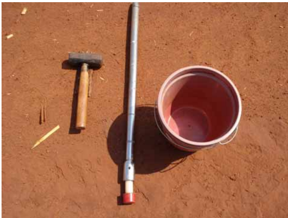
Figura 2. Ferramentas utilizadas na amostragem de solo.
