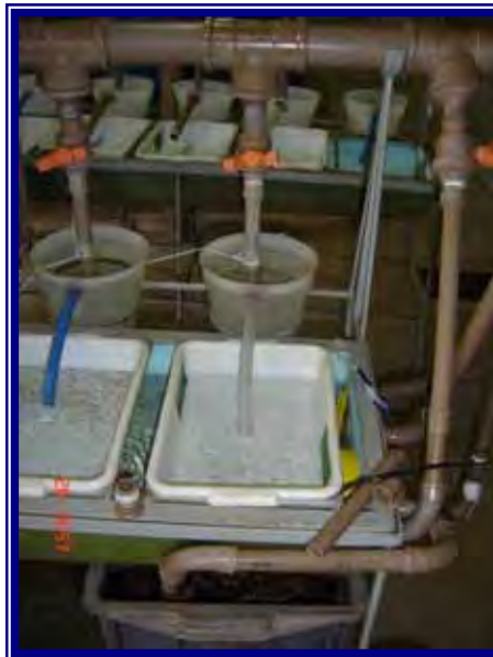
Figura 2. Incubadora artificial de tilápia, apresentando o copo cônico e a bandeja.
