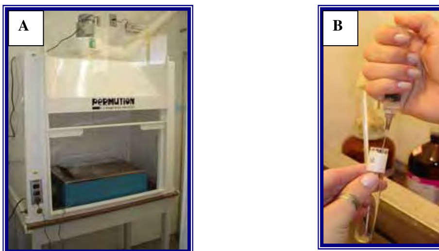
Figura 13. Capela com fluxo de ar com banho-maria em seu interior a uma temperatura de 37°C figura da esquerda (A) e da direita (B) lava-se a parede do tubo com um mL de éter, com o auxílio de um seringa e uma agulha descartável de 5 mL.
