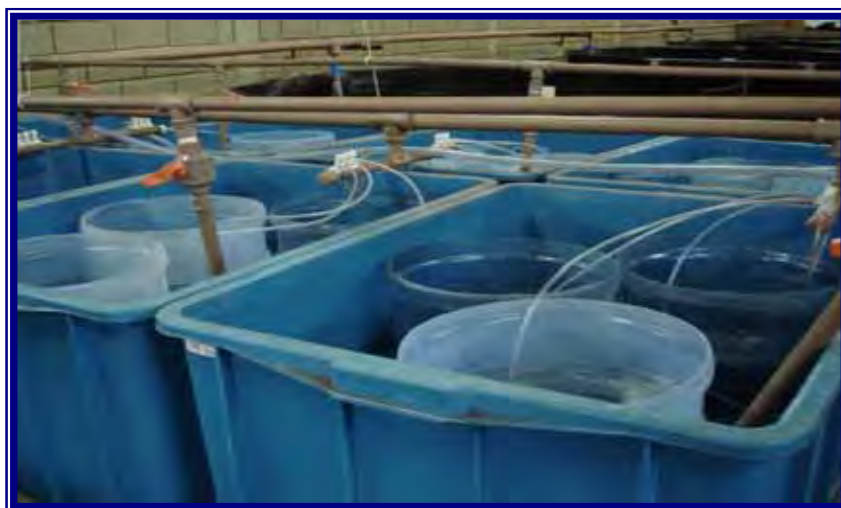
Figura 3. Caixa com quatro aquários com capacidade de 20 L, em banho-maria, e as mangueiras de ar providas de pedra porosa.
