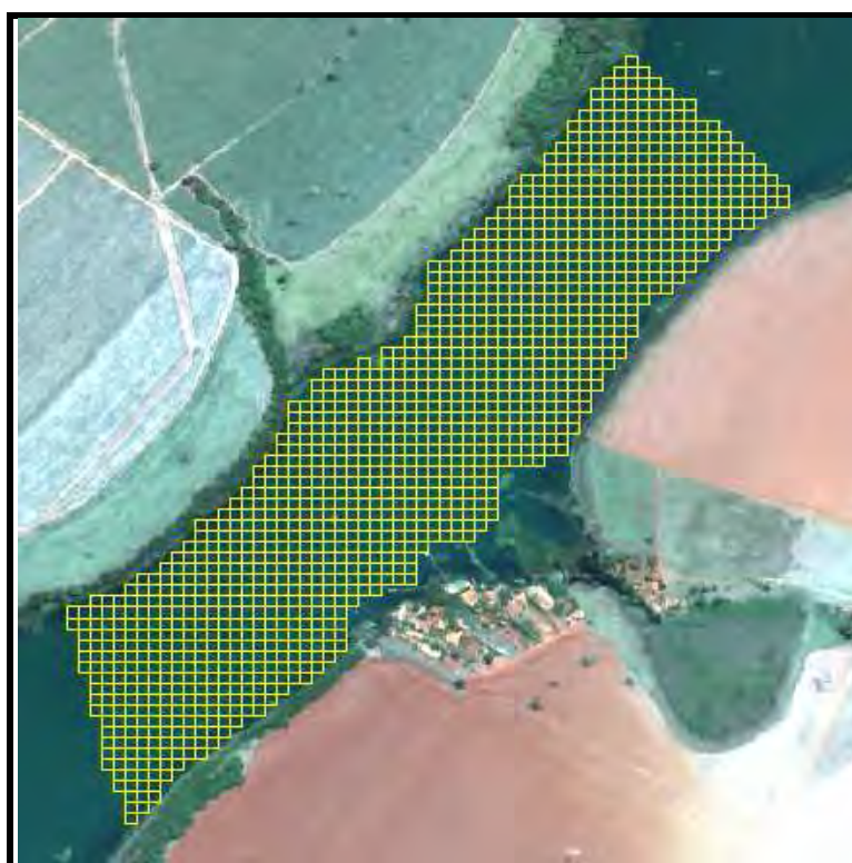
Figura 42 – Células (15 x 15 metros) contendo as informações da resposta espectral (QuickBird), profundidade e altura das macrófitas
