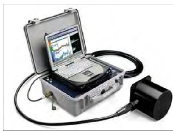
Figura 11 – Ecobatímetro Biosonics DT-X Fonte: BIOSONICS INC (2010)
