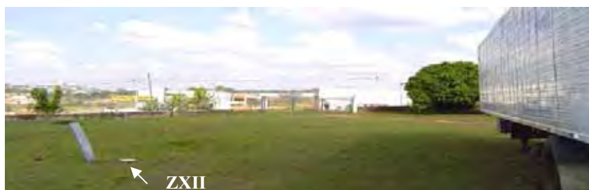
Figura 39 – Cenário do experimento para avaliação do posicionamento estático. Observa-se a placa e também carreta estacionada, como refletores, proporcionando a geração de sinais de multicaminhos.
