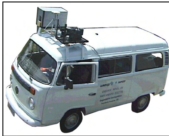
Figura 1 - Unidade Móvel de Mapeamento Digital
