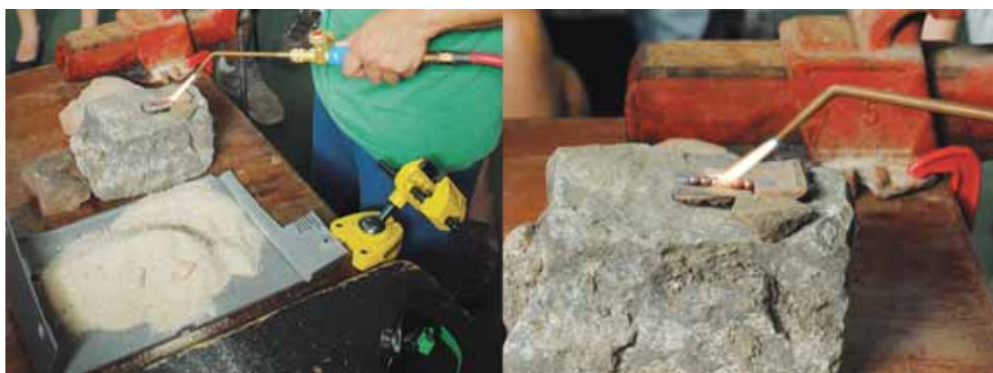
Fig. 122: tratamento para tirar dureza do metal, mostrado na Oficina de Construção em Metal para Stop Motion . Fotografia: Alessandra de Almeida Martins. 24/11/2011
