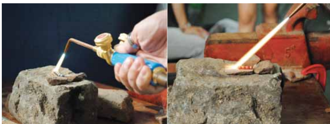
Fig. 123: tratamento para tirar dureza do metal, mostrado na Oficina de Construção em Metal para Stop Motion . Fotografia: Alessandra de Almeida Martins. 24/11/2011
