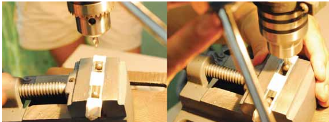
Fig. 126: furando as bolinhas de rolimã, na Oficina de Construção em Metal para Stop Motion . Fotografia: Alessandra de Almeida Martins. 24/11/2011
