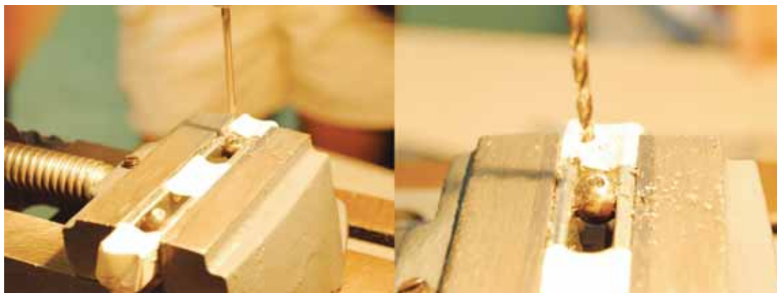
Fig. 129: furando as bolinhas de rolimã, na Oficina de Construção em Metal para Stop Motion . Fotografia: Alessandra de Almeida Martins. 24/11/2011
