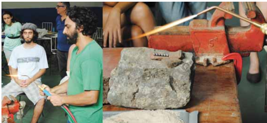
Fig. 121: tratamento para tirar dureza do metal, mostrado na Oficina de Construção em Metal para Stop Motion . Fotografia: Alessandra de Almeida Martins. 24/11/2011
