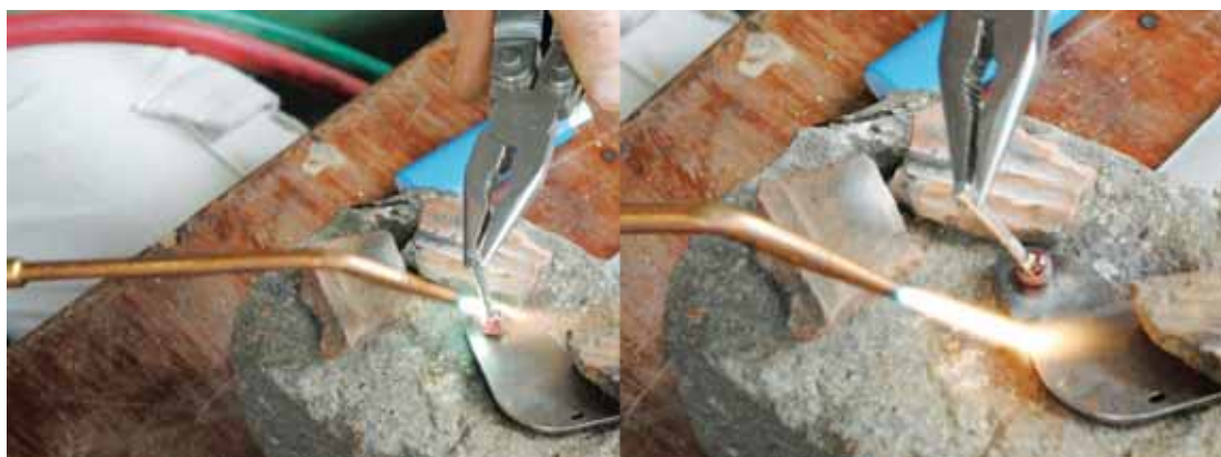
Fig. 131: solda do prego na bolinha de rolimã, na Oficina de Construção em Metal para Stop Motion . Fotografia: Alessandra de Almeida Martins. 25/11/2011
