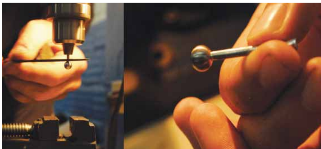
Fig. 133: polimento da peça pronta para confecção de esqueleto, na Oficina de Construção em Metal para Stop Motion . Fotografia: Alessandra de Almeida Martins. 25/11/2011
