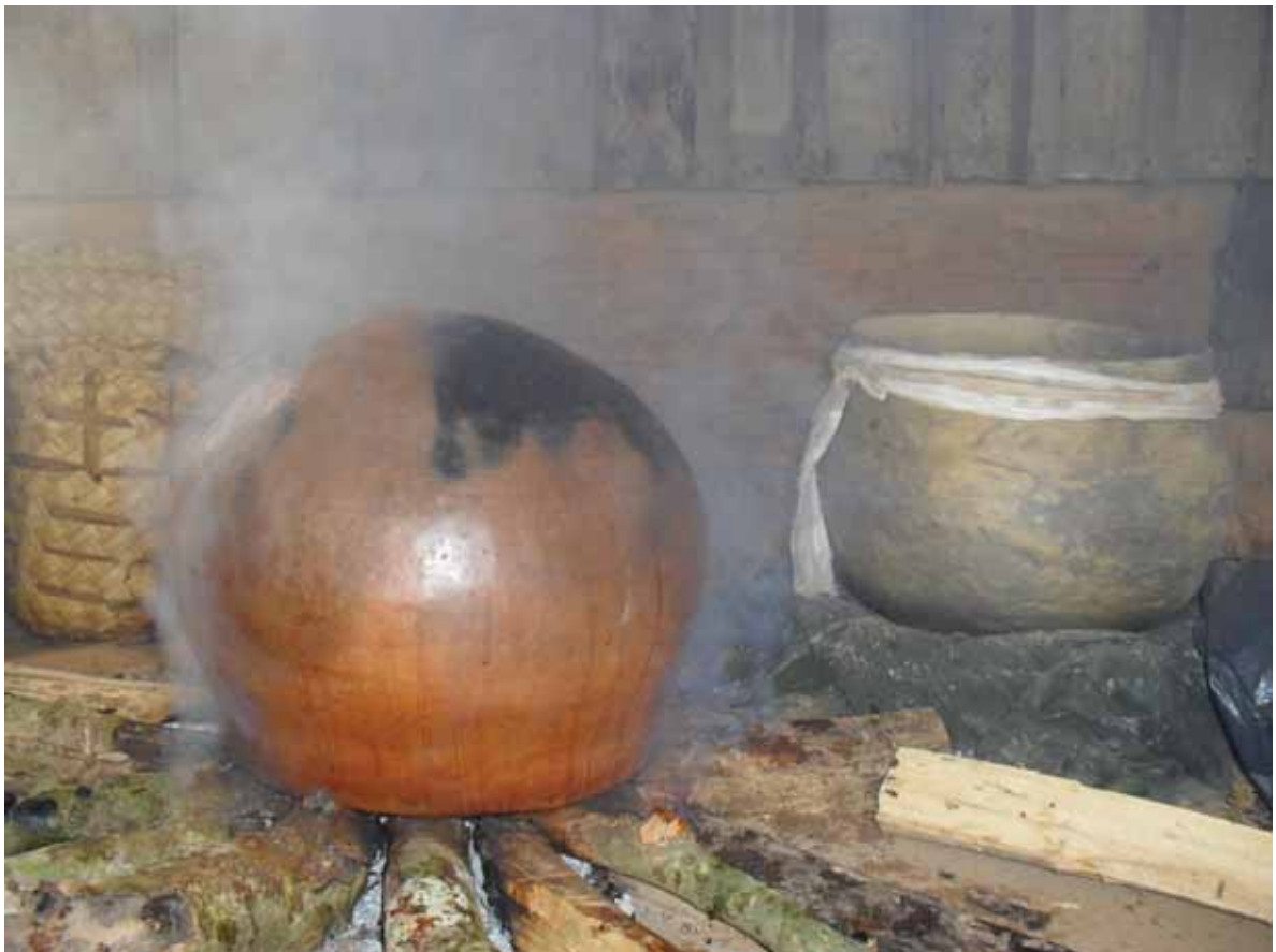
Figura 73 - Esfumaçamento interno da peça cerâmica – 2010.
