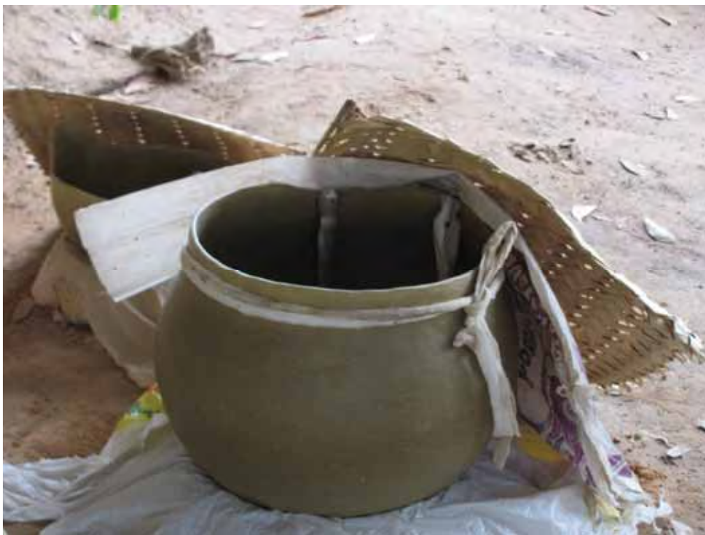
Figura 58 - Proteção da peça durante a secagem para evitar trincas e rachaduras. - 2010.
