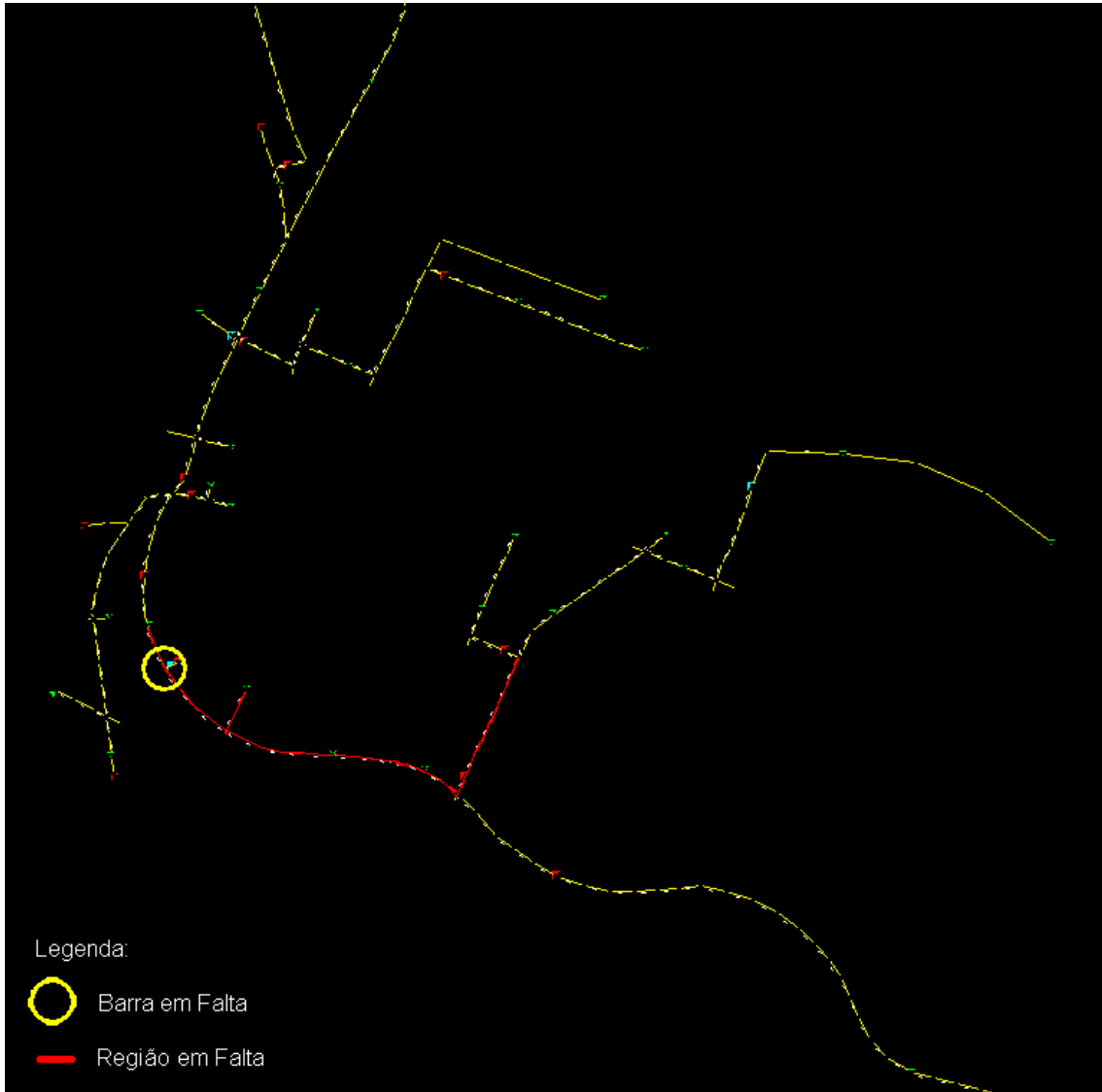
Figura 4.35 Falta na barra 3243 e provável região em falta. (região vermelha)
