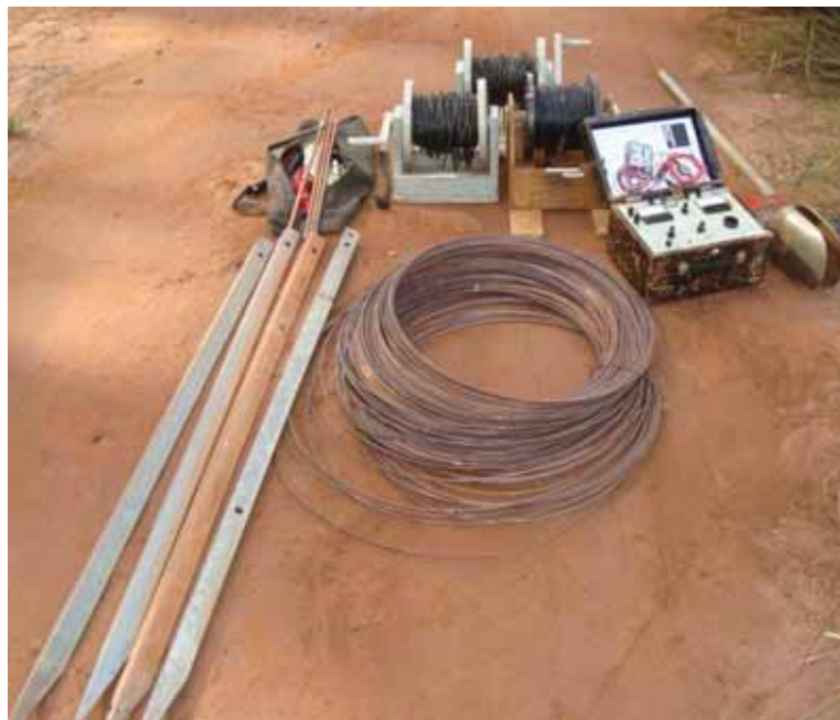
Figura 4.11: Acessórios utilizados nas medições de resistência de aterramento e resistividade do solo
