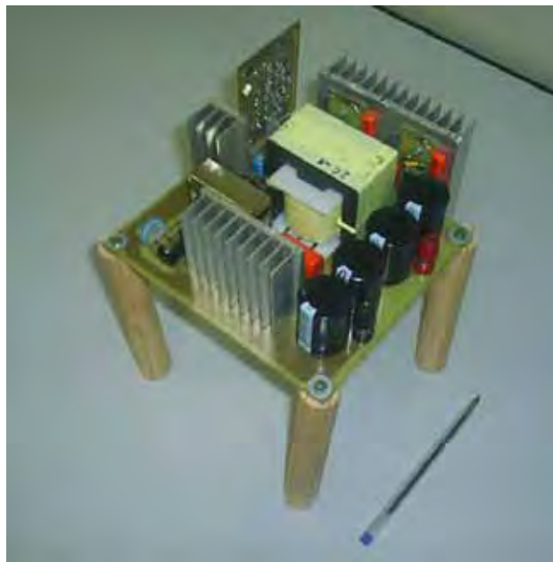
Figura 2.12. – Foto do protótipo do estágio pré-regulador retificador Boost.
