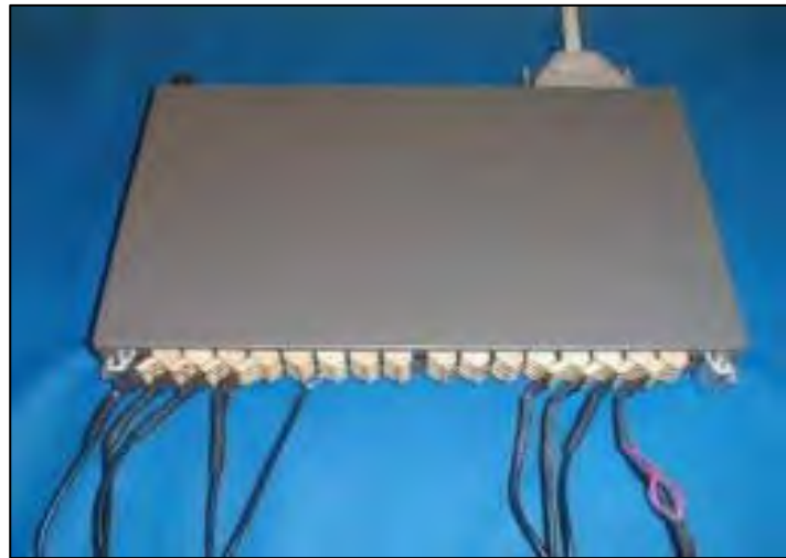
Figura 7. Módulo condicionador de sinais analógicos, modelo MCS-1000-V2, marca Lynx com 16 canais de entrada.
