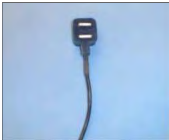
Figura 5. Eletrodo bipolar ativo de superfície para captação de sinal eletromiográfico (Lynx).
