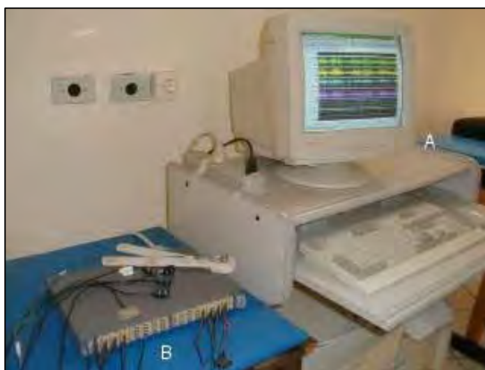
Figura 8. Conjunto formado pelo computador Pentium 233 MHz com Aqdados 5 (A), e o condicionador de sinais com eletrodos e eletrogoniômetro conectados (B).
