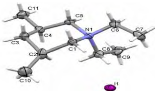
Figura 59- Estrutura tridimensional do SDA 10 obtida do seu monocristal.
