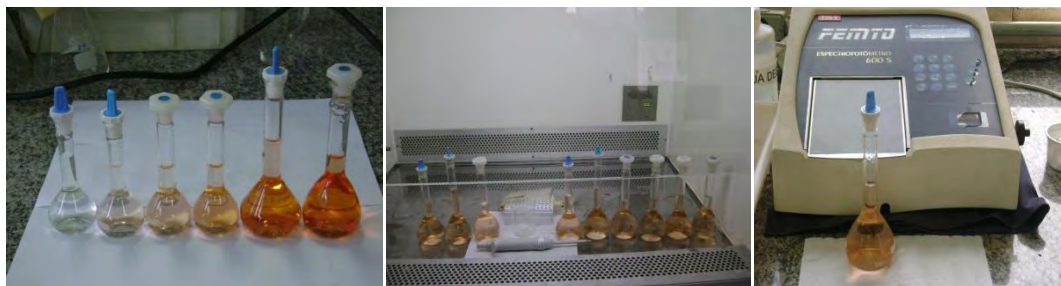
Figura 9. Demonstração das diferentes intensidades de cor, dependendo da concentração do complexo Fe(II)-fenatrolina
