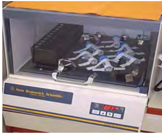
Figura 11. Processo de agitação contínua das veias em contato com o detergente químico, em equipamento Shaker . Detalhe interno, com os tubos cônicos contendo as veias em presença do detergente com fixação dos tubos para agitação orbital. Foto: arquivo do LEC, 2011
