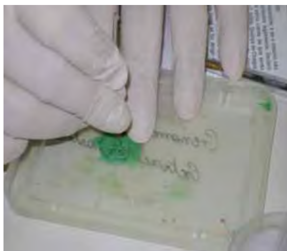
Figura 4- Selamento do capilar com massa.
