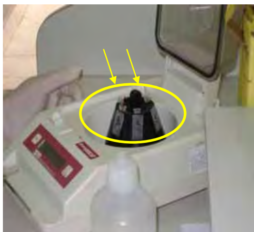
Figura 5- Balanceamento da centrífuga.
